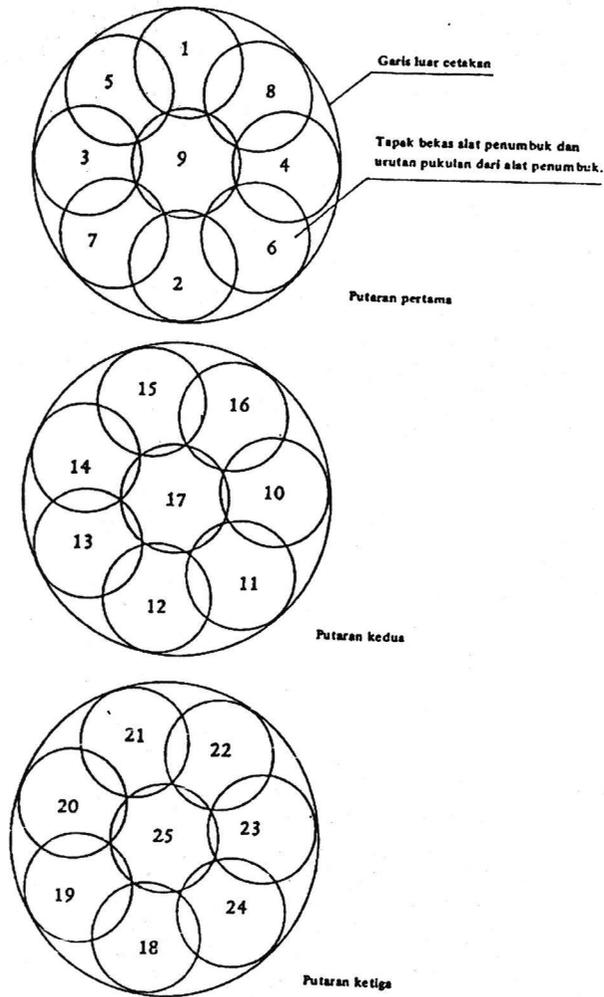
**Gambar A.3** Cara melakukan penumbukan pada cetakan berdiameter 102 mm (4 inci) untuk satu lapisan, sebanyak 25 tumbukan
