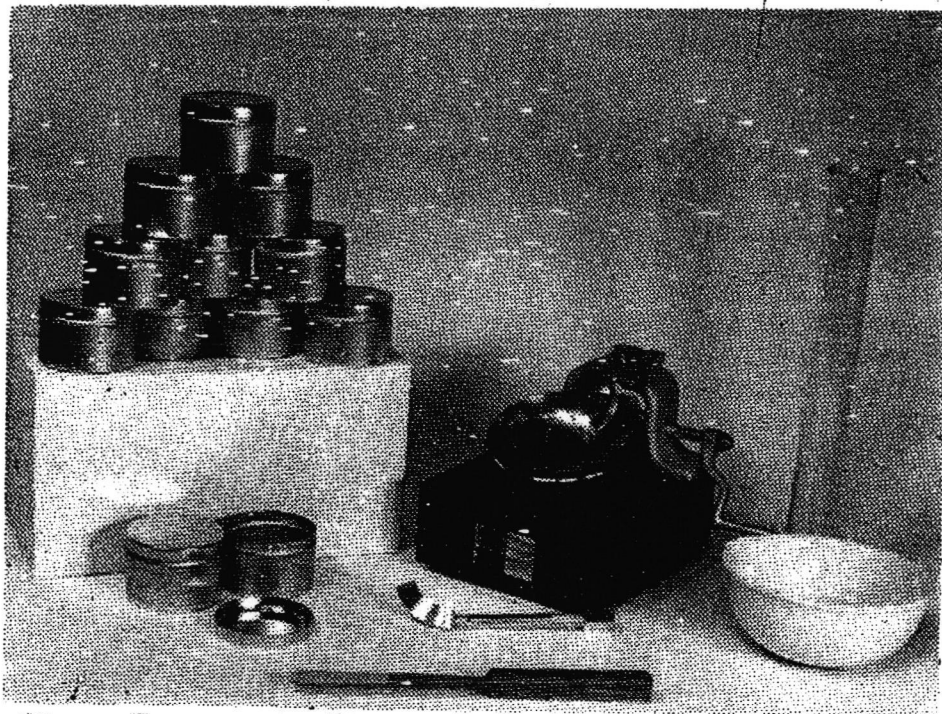
Gambar A.3a Alat batas cair, cawan, mangkok pengaduk, spatula dan pembuat alur lengkung
